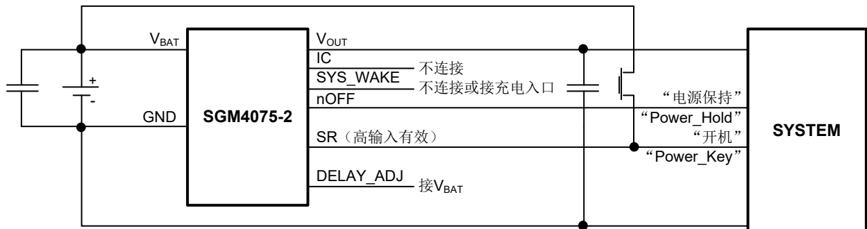
图 1. 采用惯用“开机”和“电源保持”2个控制信号的应用电路
